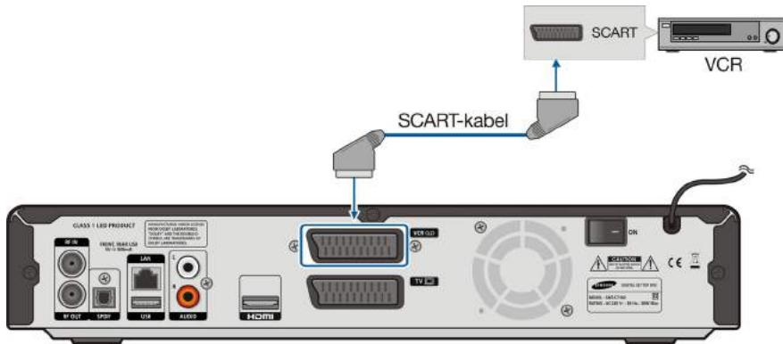
Anslut porten **VCR SCART** på baksidan av digitalboxen till en **SCART**-port på videobandspelaren via en SCART-kabel.
