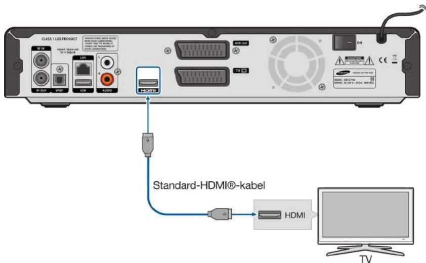
Anslut porten **HDMI** på baksidan av digitalboxen till en **HDMI**-port på TV:n via en HDMI-kabel.
