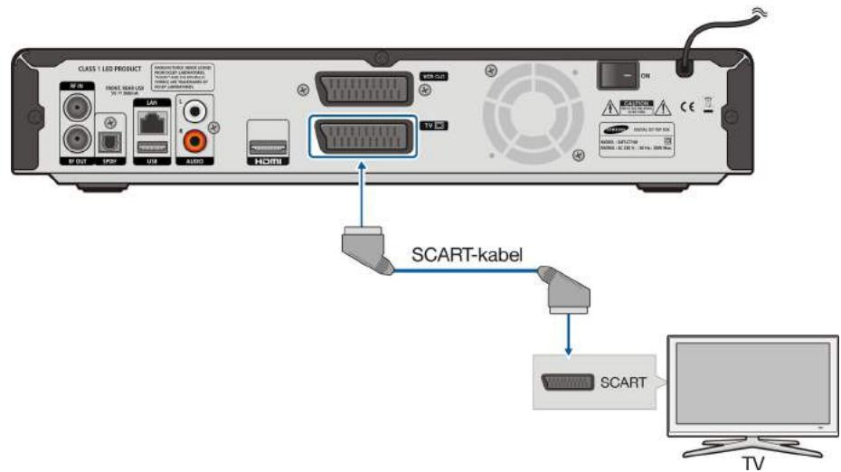
Anslut porten **TV SCART** på baksidan av digitalboxen till en **SCART**-port på TV:n via en SCART-kabel.
